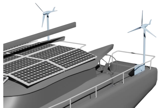
Şekil 9. Rüzgâr türbinlerinin tekne güvertesi üzerinde yerleşimi.
