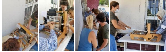
Görsel 15: Sedefli Battaniye İçin Taharlama, Tarak, Bağlama İşlemi, Fotoğraf: Mine Beşen Yalçın, 28.06.2021
