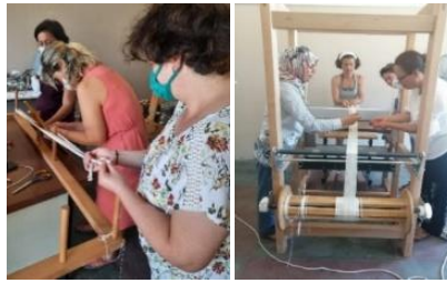
Görsel 20: 4 Çerçeveli/Pedallı Tezgah İçin Çözgü Hazırlığı, Tahar İşlemi, Fotoğraf: F. Yelda Gezicioğlu, 30.06.2021
