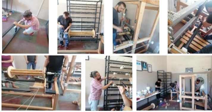
Görsel 19: Çözgü Makinesi ve Tezgahın Kurulumu 18 , Fotoğraf: Mine Beşen Yalçın, 29.06.2021
