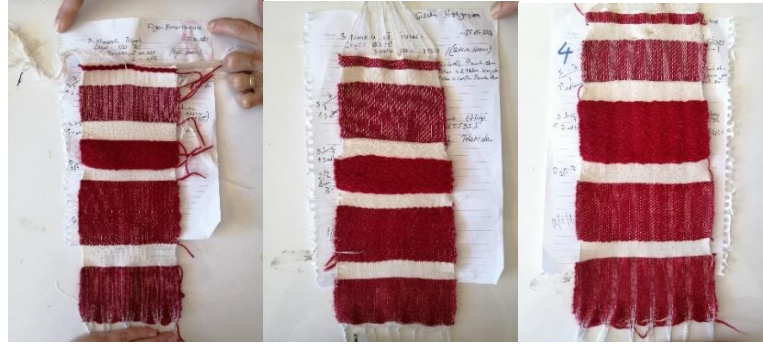
Görsel 14: 2, 3 ve 4 No'lu Tezgahta Farklı Tarak Geçişli Temel Örgü Denemeleri, Yüzey Farklılıkları, Fotoğraf: Mine Beşen Yalçın, 25.06.2021
