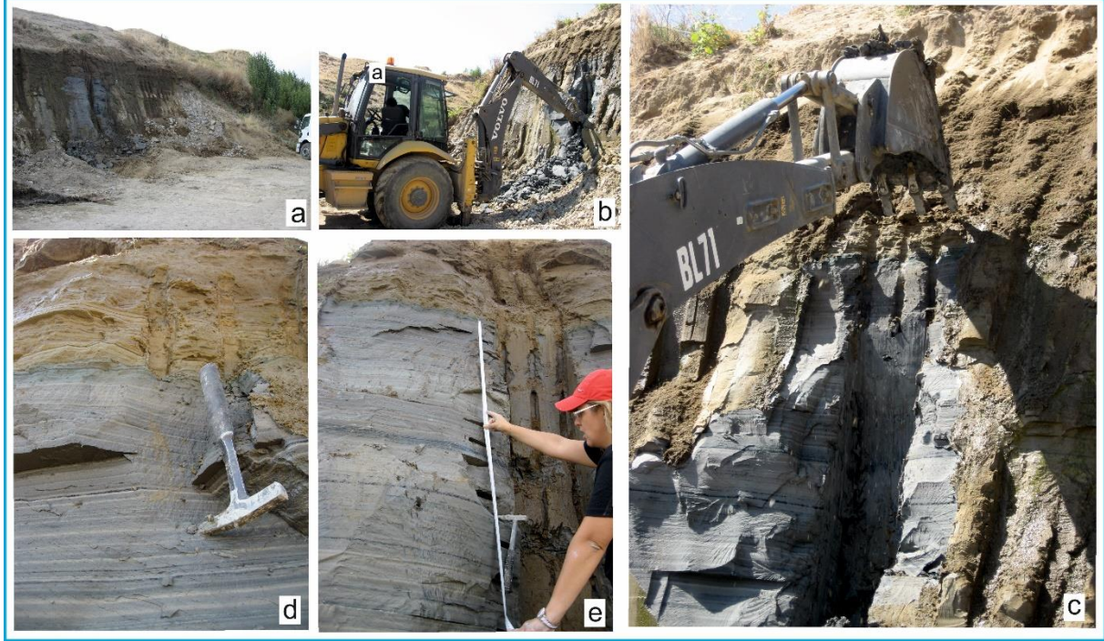
Şekil 1. a) Örnekleme yapılmamış, örtülü bir derin göl istifi, b) ve c) İstif üzerindeki döküntünün ekskavatör ile uzaklaştırılması, d) Palinolojik örnekleme yapılabilecek temiz yüzey ve detaylı olarak görülebilen, laminalı ritmik derin göl çökelleri, e) Belirli aralıklarla palinolojik inceleme yapmak üzere örneklenmiş istif.
