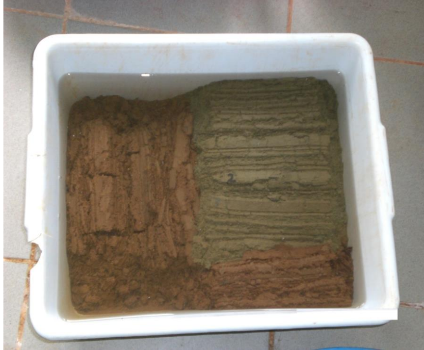
Şekil 6. 500°C'ye kadar pişirilen tuğlaların su ortamında dağılımları [4]
