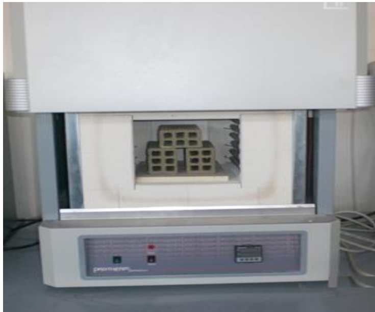
Şekil 5. 1400°C ısıtma kapasiteli Thermoterm marka yüksek fırın
