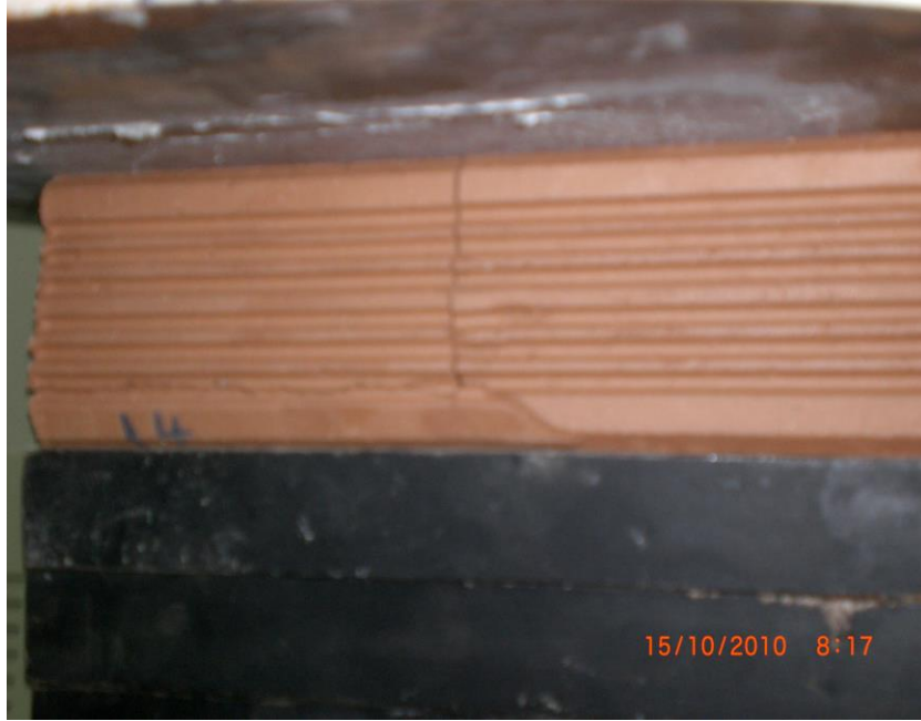
Şekil 10. 600 °C de pişen tuğlaların dayanım testinden sonraki kırılma düzlemi
