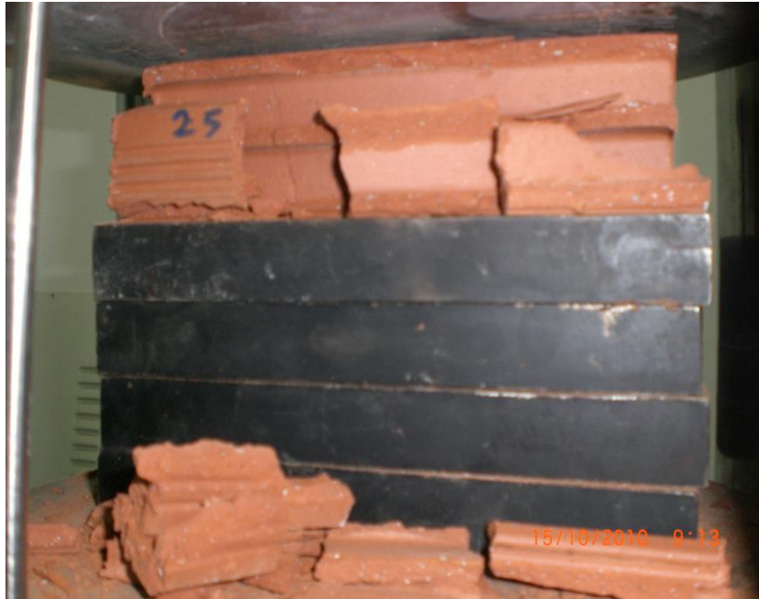
Şekil 11. 1000 °C de pişen tuğlanın dayanım testinden sonraki kırılması
