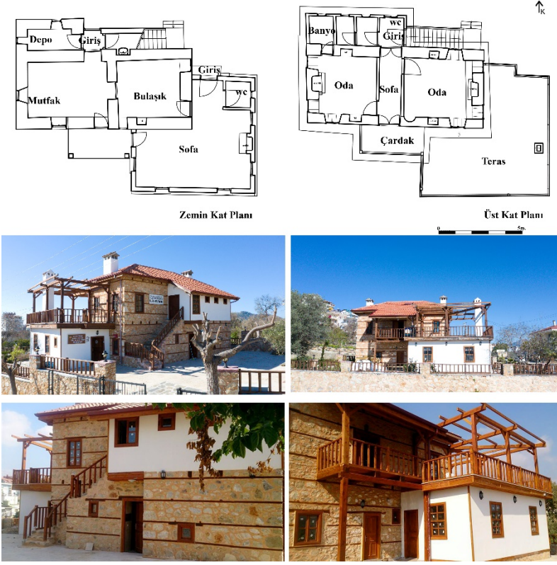
Şekil 4. Gümrük Binası Şematik Kat Planları ve Resimleri (Kaynak: Çizim ve fotoğraflar: Yazar, 2019)
