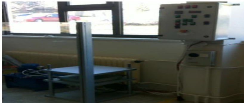
Şekil 2. Hidrolik Pompa, Hidrolik Sıcak Pres ve Kontrol Ünitesi
