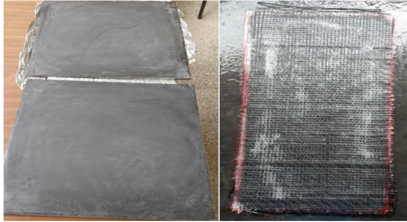
Şekil 1. Kullanılan kalıp ve reçine sürülmüş elyaflar
