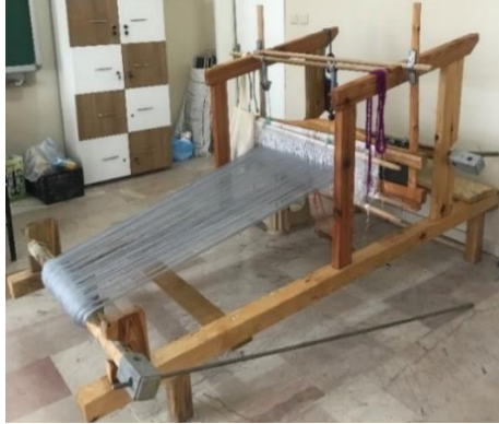
Fotoğraf 1. Dokuma tezgâhı “Düzen” (Özcan, 2021)
