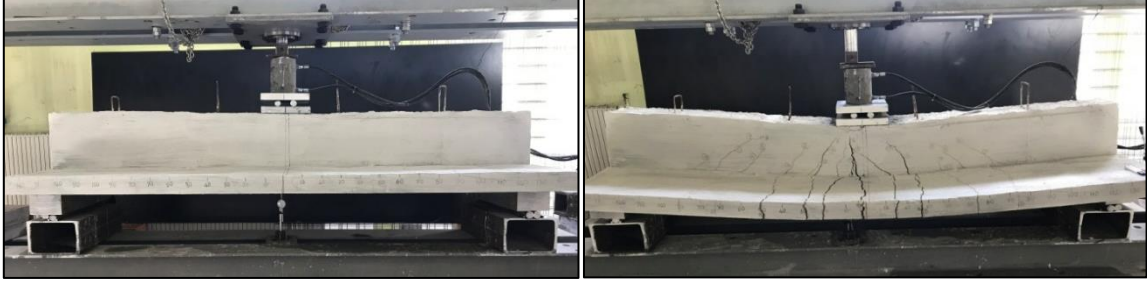
Şekil 10. K1 kirişi ve göçme şekli.
