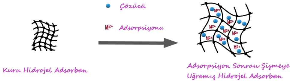
Şekil 1. Hidrojel sorbanların sulu ortamda şişmesi
