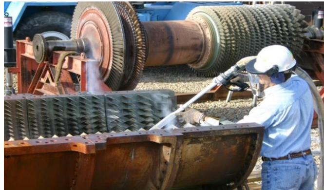
Şekil 7. Aşındırıcı Püskürtme Yöntemi (Igie, 2017).
