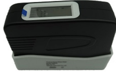
Şekil 1. Yüzey parlaklık ölçüm cihazı Figure 1. Surface gloss meter
