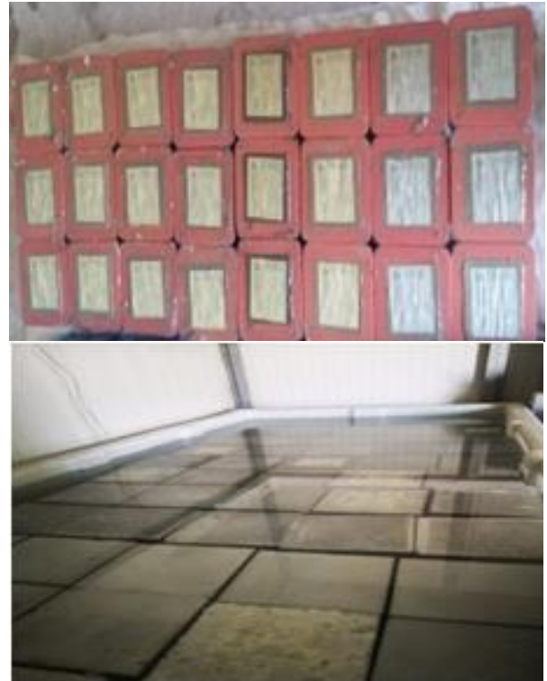
Şekil 3. Numune kalıplarına dökülmüş taze beton örnekleri ve kürleme işlemi
