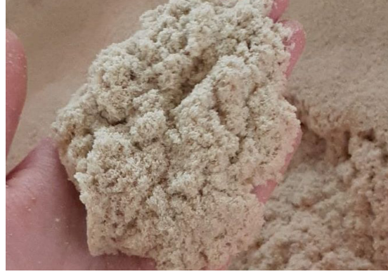
Figure 6. Bamboo fibers in 1 mesh size coming out of the vibrating sieve Şekil 6. Sarsak elekten çıkan 1 mesh boyutundaki bambu lifleri
