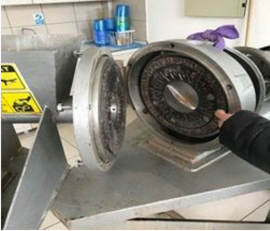
Figure 5. Refiner machine Şekil 5. Rafinör makinesi
