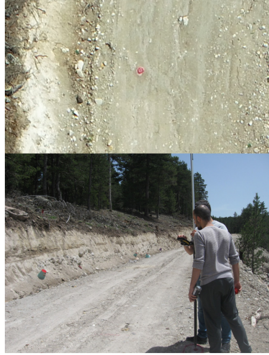
Şekil 3. Üst)YKN'nin alana işaretlenmesi, alt) Cors-GPS ile koordinatlarının alınması Figure 3. Top) Marking the YKN to the area, bottom) getting its coordinates with Cors-GPS
