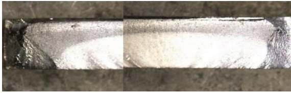
Şekil 6. Kusur içermeyen numunede kesitten SM kırık yüzey görüntüsü (Figure 6. SM fracture surface from cross-section in non-defected sample)
