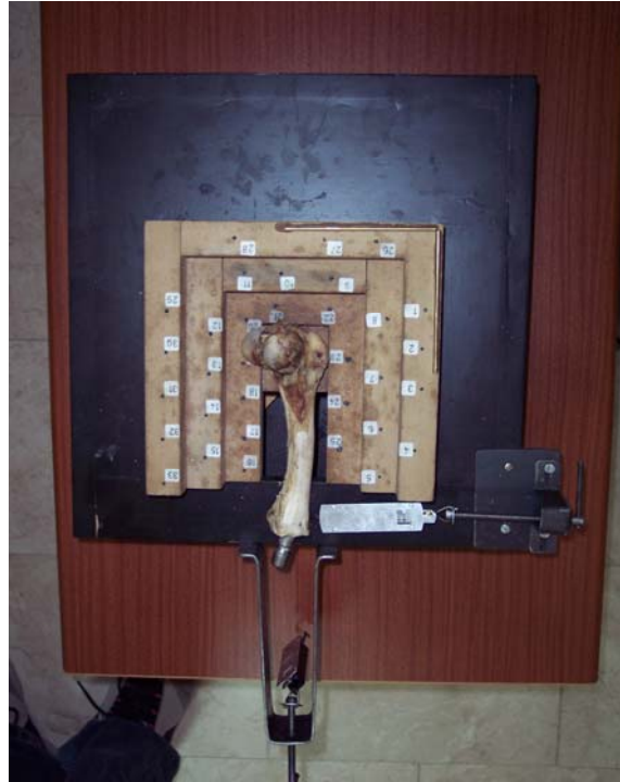
Şekil 2. Güç sensörü eklenmiş kalibrasyon kutusu.
