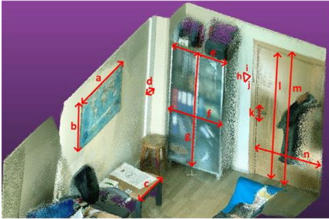
Şekil 4. Nokta bulutlarının doğruluk analizi için çelik şerit metre (ÇŞM) ile ölçülen ayrıtlar
