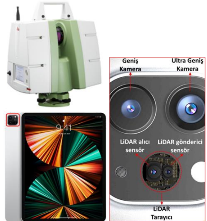
Şekil 1. Çalışmada kullanılan donanımlar; (üstte) Leica ScanStation C10, (altta) 12.9 inç Apple iPad Pro
