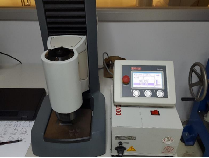
Şekil 16. Emcotest Durajet Sertlik ölçüm cihazı (Figure 16. Emcotest Durajet Hardness Tester)
