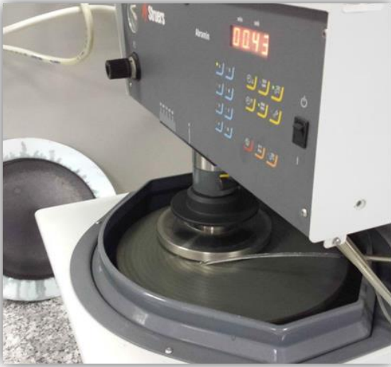
Şekil 11. Struers Abramin zımparalama ve parlatma cihazı (Figure 11. Struers Abramin sanding and polishing device)
