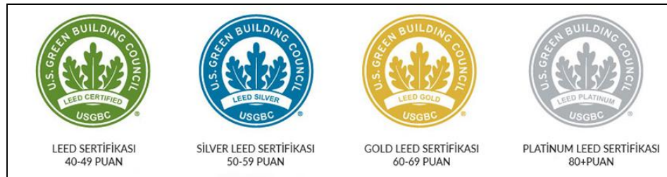
Şekil 1. LEED Sertifika Seviyeleri ve Puan Durumu [18]
