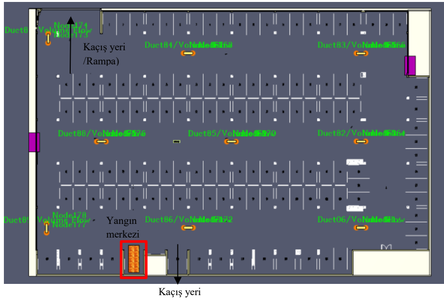
Şekil 5: Örnek bir kurum binasının kapalı otoparkında bulunan radyal/eksenel jet fanların yerleşimi
