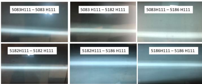
Şekil 3. 5083 H111-5083 H111, 5083 H111-5182 H111, 5083 H111-5186 H111, 5182 H111-5182 H111 ve 5186 H111-5186 H111 numuneleri için radyografik muayene görüntüleri
