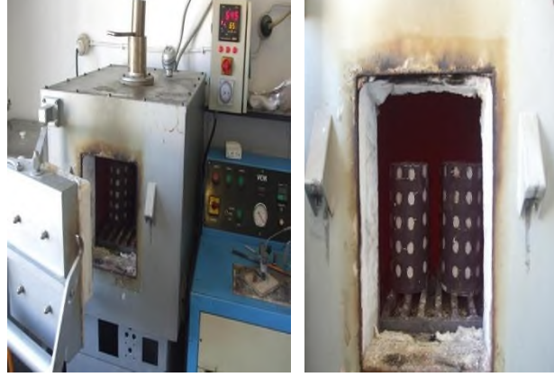
Fotoğraf 8. Alçı fırınlama işlemi (Nil Döküm, 2009).
