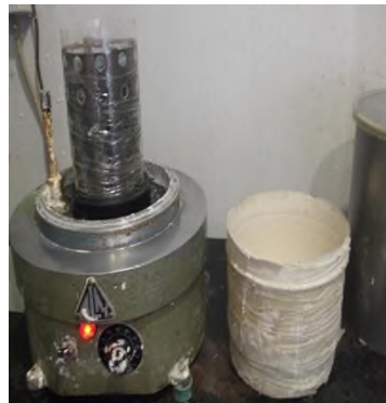
Fotođraf 5. Fanusun alçılama öncesi vakum makinesinde havasının alınma işlemi (Nil Döküm, 2009).
