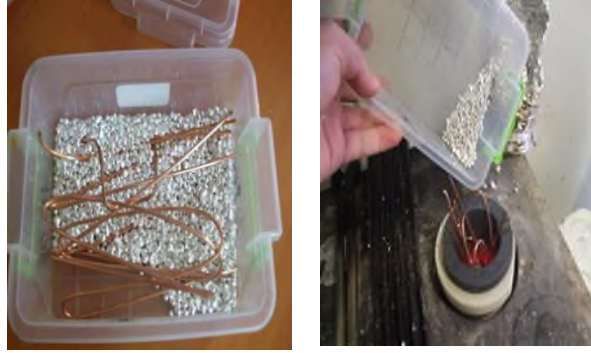
Fotoğraf 9. Alaşımın ayarlanıp potada eritilmesi işlemi (Nil Döküm, 2009).
