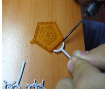
Fotoğraf 2. Reçine modele lehim aletiyle yolluk ismi verilen mum ağacına dizim işleminde kullanılan mum sapın lehimlenmesi (Nil Döküm, 2009).
