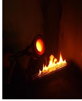
Fotoğraf 10. Eriyen metalin oluklu şideye dökülmesi işlemi (Nil Döküm, 2009).
