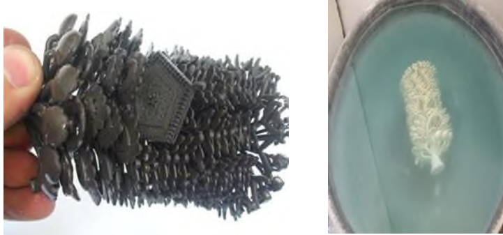
Fotoğraf 14. Alçıdan temizlenmiş modeller ve nitrik asitli suya atılarak ağartılması işlemi (Nil Döküm, 2009).
