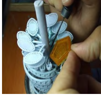
Fotođraf 3. Reçine modelin lehim aleti yardımı ile mum ağaca eklenmesi (Nil Döküm, 2009).
