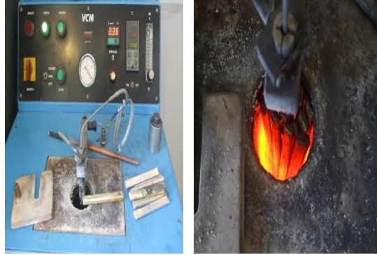
Fotoğraf 11. Dökümde kullanılacak metalin döküm makinesine eritmek üzere atılması işlemi (Nil Döküm, 2009).
