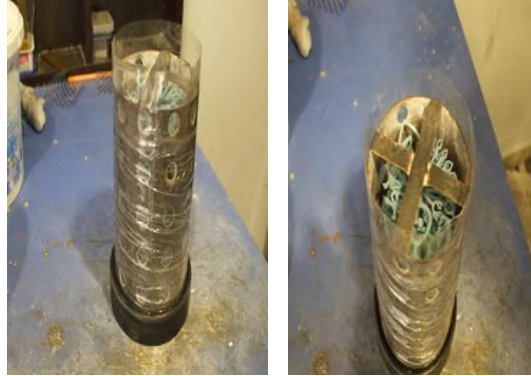
Fotođraf 4. Mum modellerin olduđu ağacın alçıya alma işlemi öncesi fanusa yerleştirilmesi işlemi (Nil Döküm, 2009).
