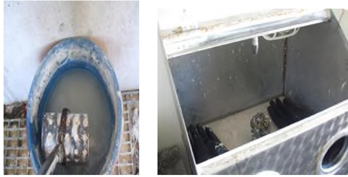
Fotoğraf 13. Döküm işlemi sonrası alçı temizleme işlemi; sıcakken soğuk suya batırılır. Fanusun kalan alçılardan tamamen temizlenmesi için alçı temizleme makinesinde basınçlı su uygulanması işlemi (Nil Döküm, 2009).
