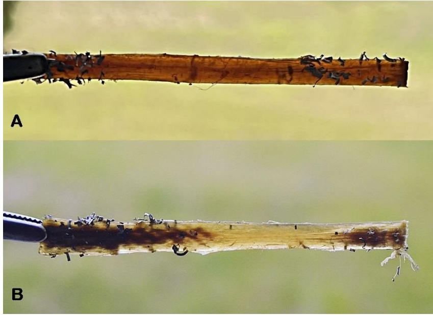
Şekil 2: Tendonların, biyomekanik test öncesi (A) ve biyomekanik test sonrası (B) görünümü. Biyomekanik test sonucunda, tendon orta seviyesinde oluşan sünme, açık renk olarak görülüyor. Germe test cihazında tendonların kaymaması için tendon uçlarına sürülen alüminyum tozları görülüyor.
