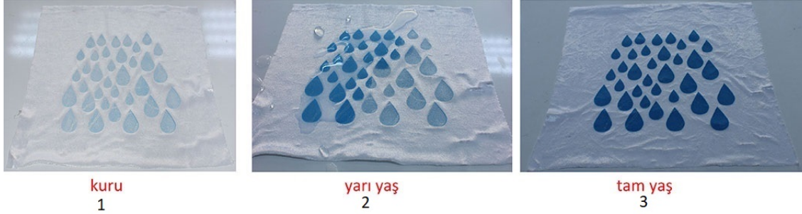
Görsel 9. 1: Hidrokromik baskı patı geçişli uygulama (kuru) 2: Hidrokromik baskı patı geçişli uygulama (yarı yaş) 3: Hidrokromik baskı patı geçişli uygulama (tam yaş)
