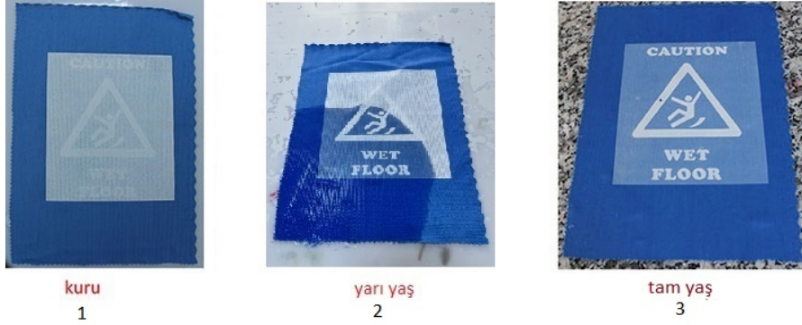
Görsel 8. 1: 4'lü hidrokromik baskı patı geçişli uygulama (kuru) 2: 4'lü hidrokromik baskı patı geçişli uygulama (yarı yaş) 3: 4'lü hidrokromik baskı patı geçişli uygulama (tam yaş)
