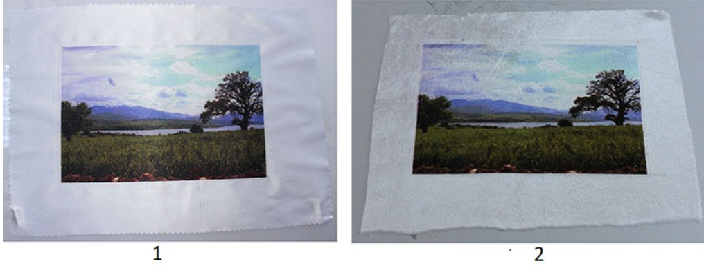
Görsel 10. 1: 4 numaralı dokuma saten kumaş transfer baskı görünümü 2: 5 numaralı triko saten kumaş transfer baskı görünümü
