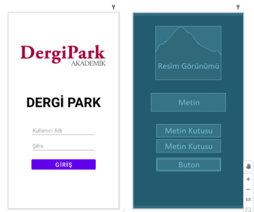
Şekil 1: Bir Android uygulaması için hazırlanan örnek ön yüz tasarımına ilişkin Android Studio ortamından alınan ekran görüntüsü.
