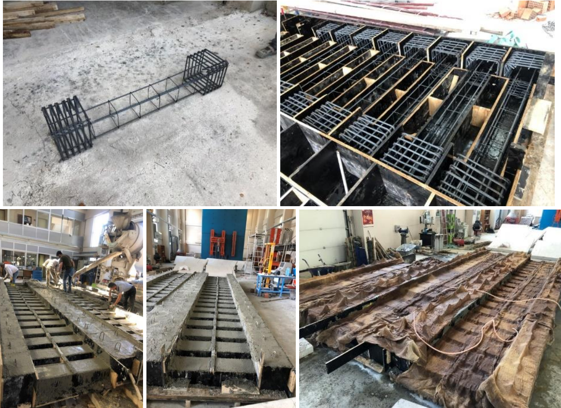
Şekil 3. Deney elemanlarının üretilmesi ve kürlenmesi
