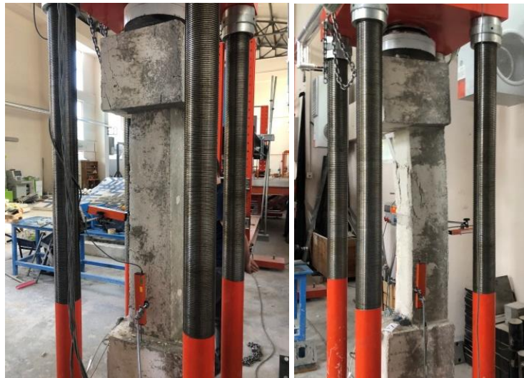
Şekil 9. Referans deney elemanlarının hasar dağılımı
