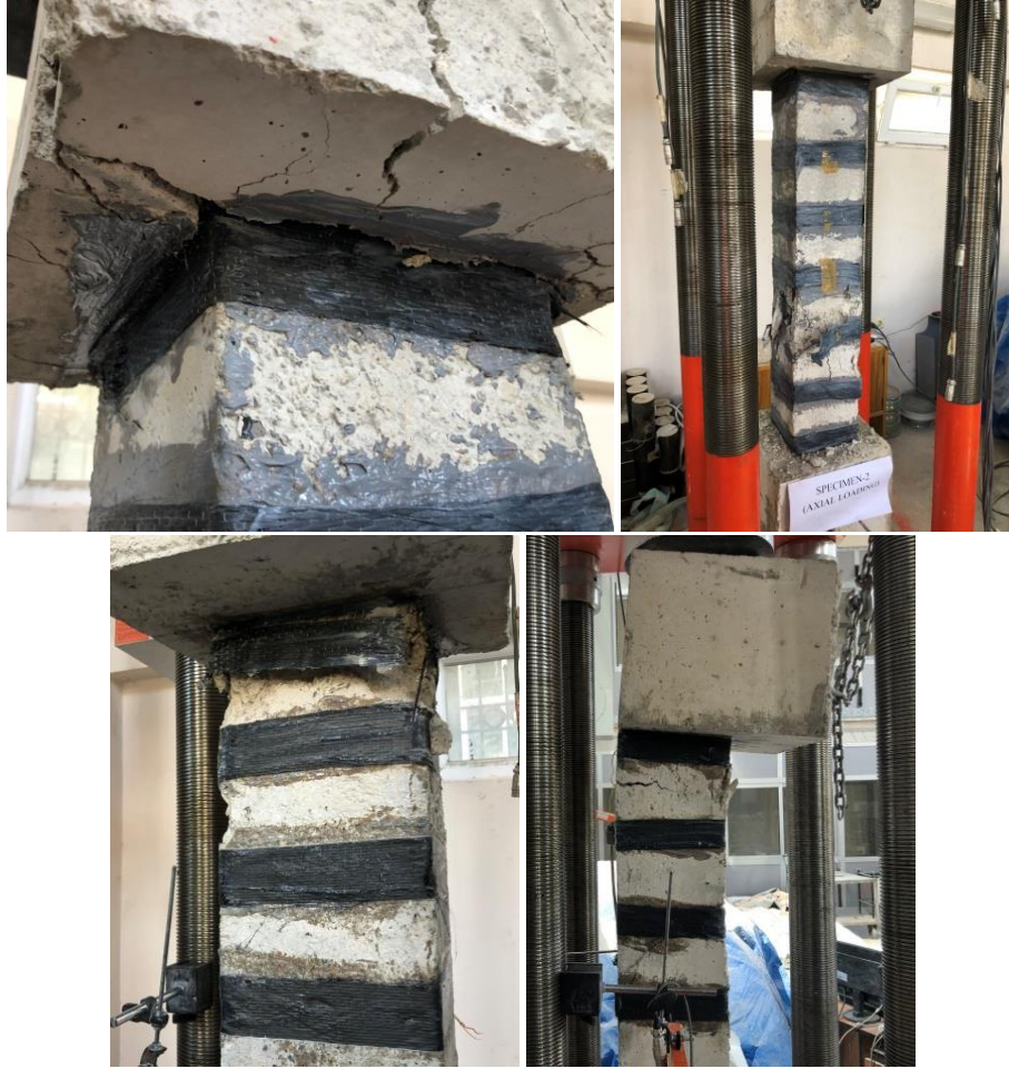
Şekil 10. Güçlendirilmiş deney elemanlarında meydana gelen hasar dağılımı
