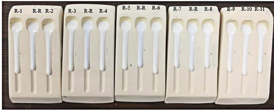
Şekil 2. İncelenen tüm sırların akma boyları (Flow length test samples of all the investigated glazes)
