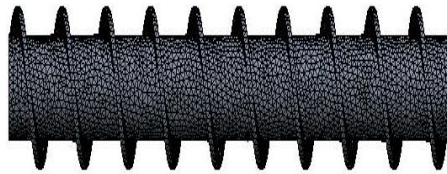
Şekil 3. Borunun Ansys ortamında sonlu eleman modeli
