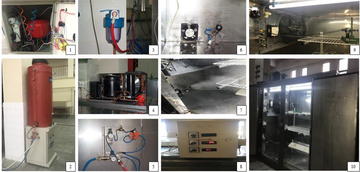
Şekil 2. Nemlendirme sisteminin ana ekipmanları (1: su arıtma sistemi, 2: su tankı, 3: hava filtresi, 4: soğutma sistemi, 5: pülverize buhar oluşturma sistemi, 6: atomizer, 7: atomizer nemlendirme sistemi, 8: sıcaklık ve % bağıl nem kontrol paneli, 9: kuru hava ısıtıcısı, sıcaklık ve % bağıl nem probu, 10: sabit sıcaklık ve bağıl nem kamarası)
