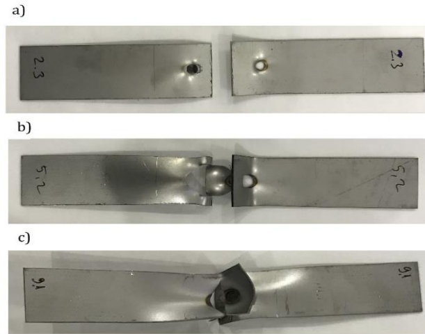
Şekil 10. Farklı kaynak parametrelerine sahip birleştirilmiş numunelerin çekme testi sonrası görüntüsü; a) 2 numaralı deney (122) b) 5 numaralı deney (223) c) 9 numaralı deney (332) (After tensile test image of the combined samples with different welding parameters; a) Experiment 2 (122) b) Experiment 5 (223) c) Experiment 9 (332))
