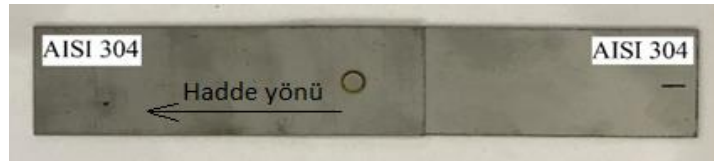
Şekil 4. Kaynak Edilmiş Çekme Deneyi Numunesi (Welded Tension Test Sample)
