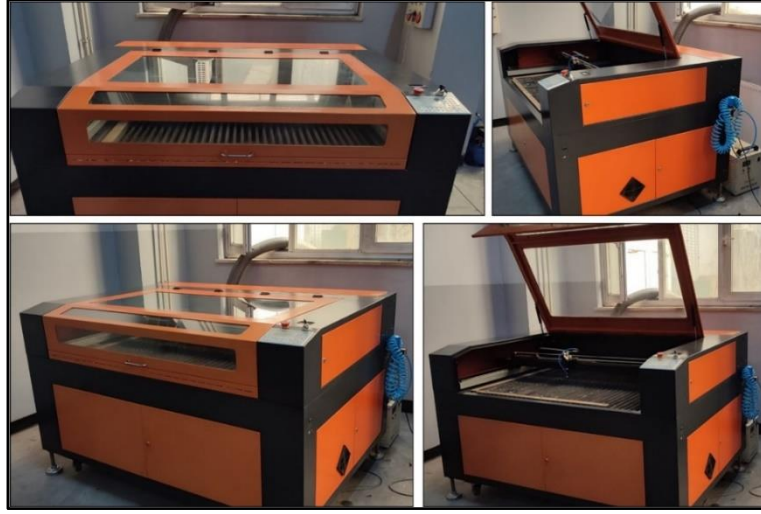
Şekil 8. Üretilen lazer işleme makinesi (The manufactured laser processing machine)
