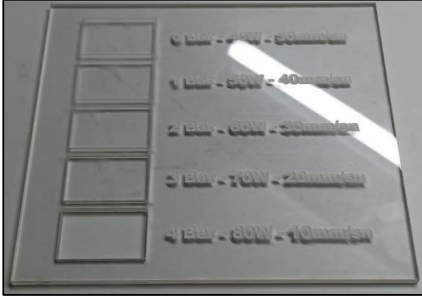
Şekil 13. Pleksi parametre çalışması (Parameter study of plexiglass)
