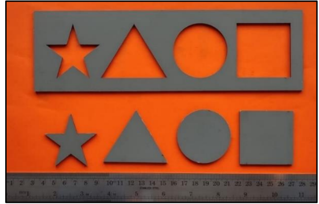
Şekil 12. MDF geometrik şekil kesim örneği (Cutting example of MDF geometric shape)
