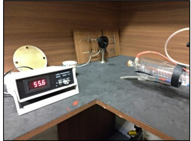
Şekil 7. Lazer güç metre ile güç ölçümü (Power measurement with laser power meter)
