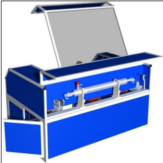
Şekil 5. Rezonatörün makine üzerine eklenmesi (Integration of the resonator on the machine)
