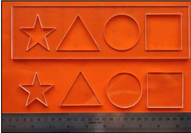
Şekil 14. Pleksi geometrik şekil kesim örneği (Cutting example of plexiglass geometric shape)
