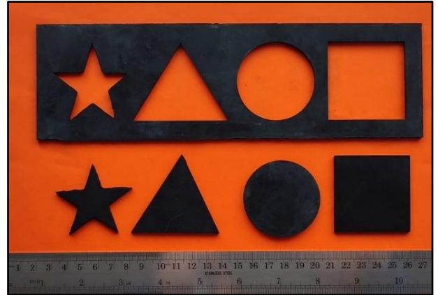
Şekil 9. Kauçuk malzeme geometrik şekil kesim örneği (Cutting example of rubber geometric shape)
