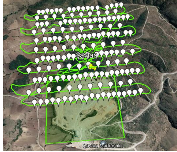
Şekil 4. SenseFly eBee X ile yapılan uçuş planı ve fotoğrafların konumları
