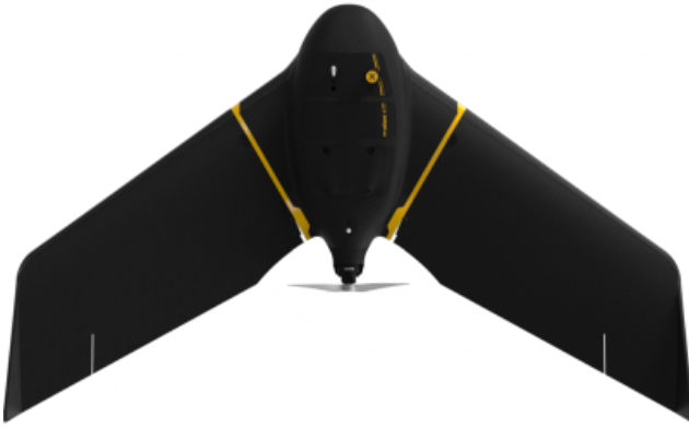
Şekil 3. SenseFly eBee X İnsansız hava aracı
