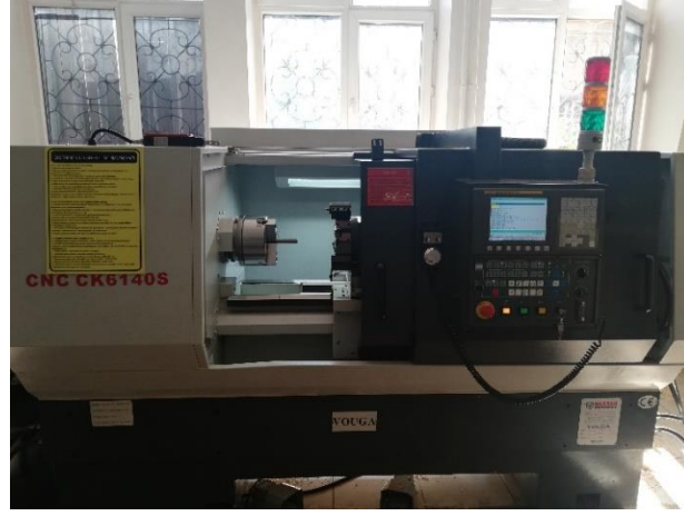
Şekil 1. VOGUA CK6140S marka CNC torna tezgâhına iş parçasının bağlanması.
