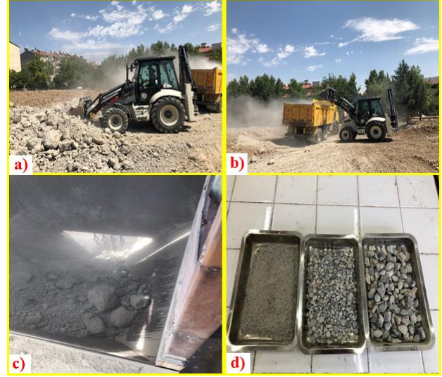
Şekil 1. GDBA'ların elde edilme aşamaları Tüm beton karışımlarında su azaltıcı kimyasal katkı olarak CHRYSO Optima 280 - SC3 süper akışkanlaştırıcısı kullanılmıştır. Beton karışımlarına ait veriler Çizelge 3'de verilmiştir.
