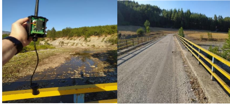
Şekil 16. Yetimli Köyü Köprüsü LDD575 paket gönderimi Figure 16. Yetimli Village Bridge LDD575 packet delivery
