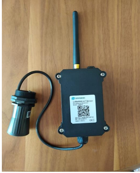
Şekil 4. Dragino LDDS75 LoRaWAN mesafe sensörü Figure 4. Dragino LDDS75 LoRaWAN distance sensor
