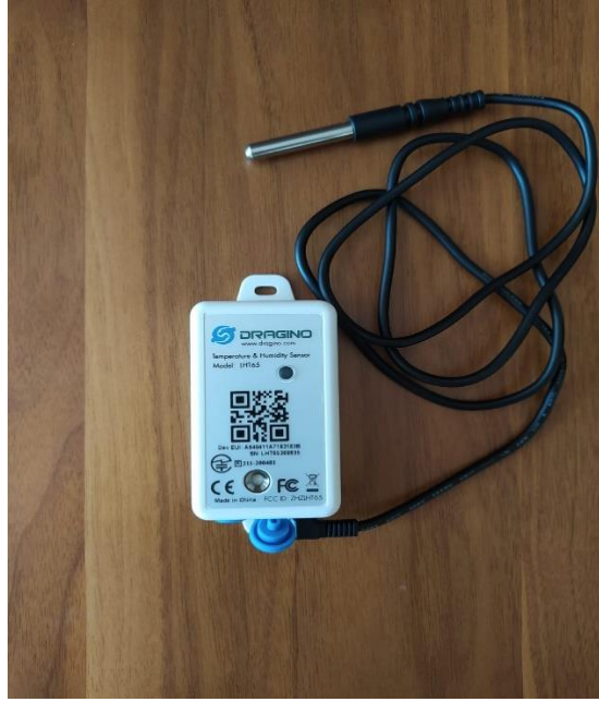
Şekil 3. Dragino LHT65 LoRaWAN sıcaklık ve nem sensörü Figure 3. Dragino LHT65 LoRaWAN temperature and humidity sensor
