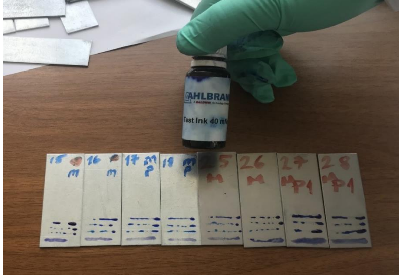
Şekil 6. Yüzey geriliminin tespiti için kullanılan 40, 48, 50 ve 32 mN/m'lik mürekkepler sonucu yüzeyin davranışı
