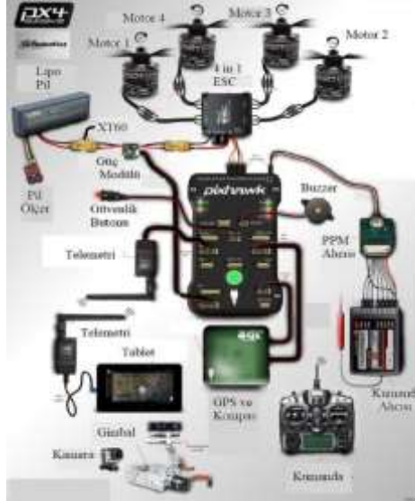
Şekil 10. Pixhawk kart ve bu kartın diğer harici takılabilir donanımları (Ardupilot, 2022) (Figure 10. Pixhawk card and other external pluggable hardware of this card (Ardupilot, 2022))
