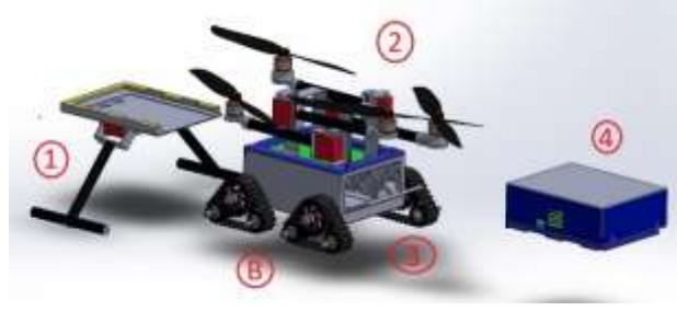
Şekil 4. Robotun kara-hava aracı kombinasyonu (B) (Figure 4. The ground-air vehicle combination of the robot (B))
