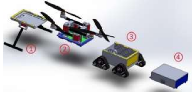
Şekil 1. Modüler yapıya sahip robotun modül numaralandırılması (Figure 1. Module numbering of the robot with modular structure)
