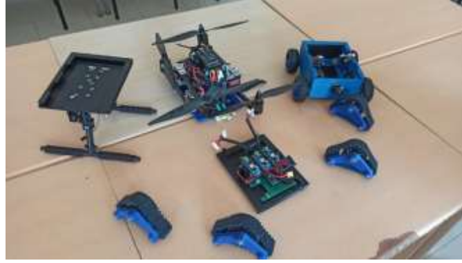
Şekil 25. Modüler yapıya sahip robotun tüm modülleri (Figure 25. All modules of the robot with modular structure)
