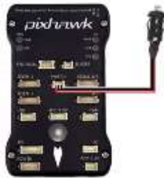
Şekil 15. Pixhawk güvenlik butonu bağlantısı (Figure 15. Pixhawk security button connection)
