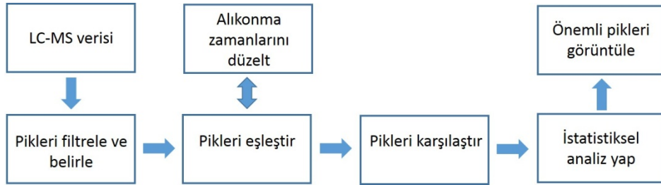
Şekil 2. XCMS Uygulamasında Kullanılan Algoritmanın Şeması 54
