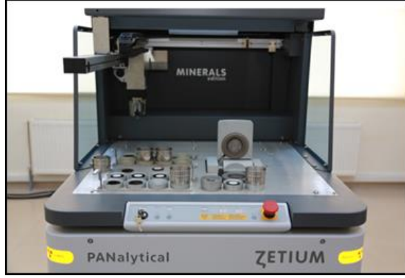
Şekil 3. Kazan altı küllerinin kimyasal analizinde kullanılan XRF (Panalytical/Zetium)
