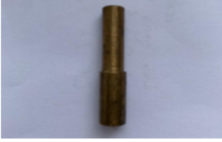
Resim 1. Çekme testi için akrilik örneklerin elde edilmesinde kullanılan pirinçten kalıp
