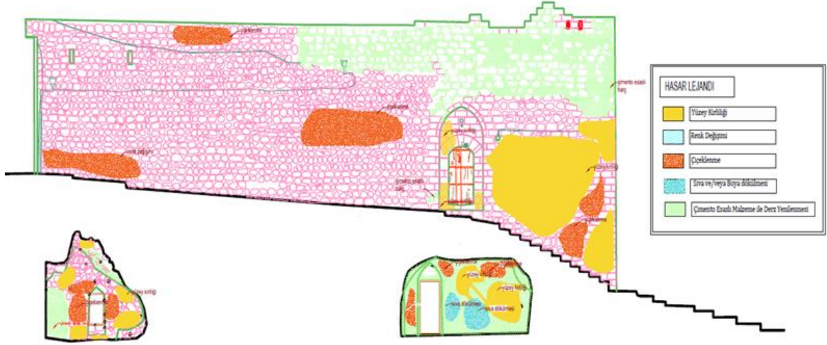
Şekil 8. Yapının batı cephesinde malzeme bozulmalarına dair analitik rölöve
