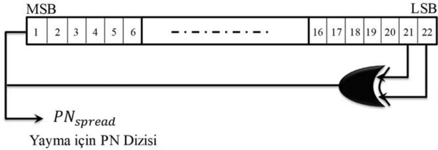
Şekil 2. Yayma PN dizisi üreticinin blok şeması (The block scheme of the spreading PN sequence generator)
