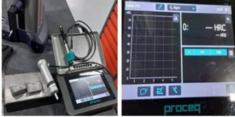
Şekil 6. Sertlik ölçümlerinde kullanılan PROJEQ marka cihaz.
