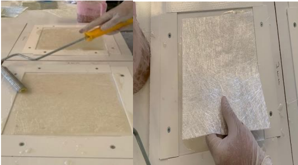
Şekil 2.6. Kalıplara takviye ve matrisin rulo fırça ile uygulanması
