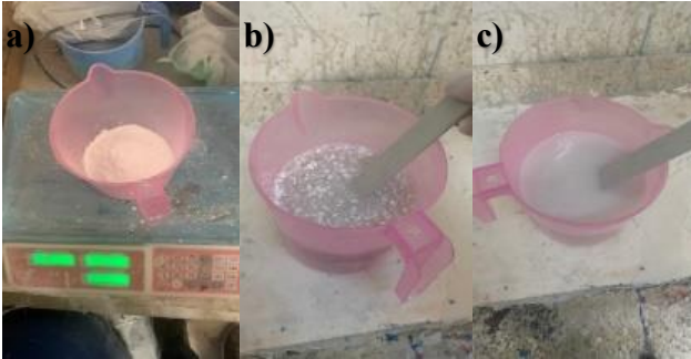
Şekil 2.5. (a) Çinko boratın ağırlıkça tartılması, (b) çinko boratın polyestere eklenmesi, (c) çinko borat ve polyestere karıştırılması
