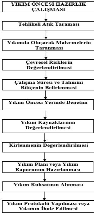
Şekil 4: Yıkım Öncesinde Hazırlık Çalışması Süreçleri (Güllü, 2020, s. 100)
