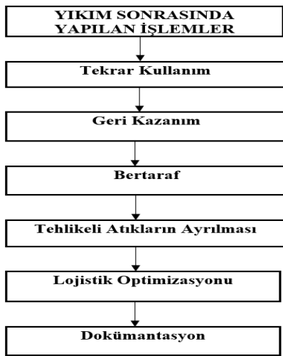
Şekil 8: Yıkım Sonrasında Yapılan İşlemler (Güllü: 2020, s. 116)
