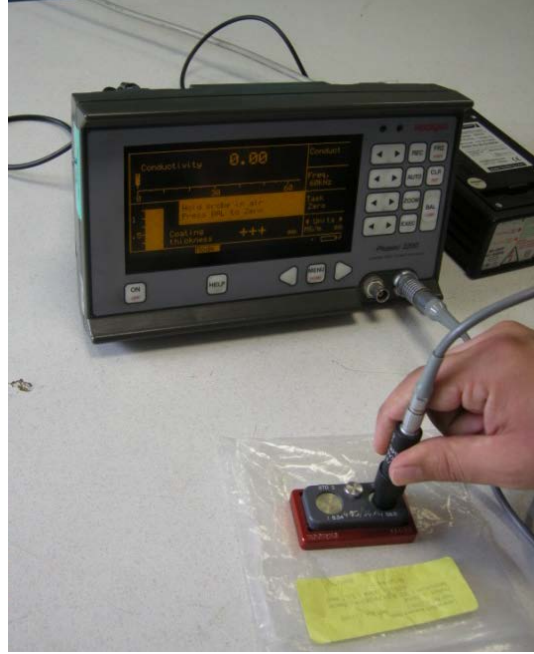
Şekil 1. Elektrik iletkenliği ölçüm cihazının genel görünüşü
