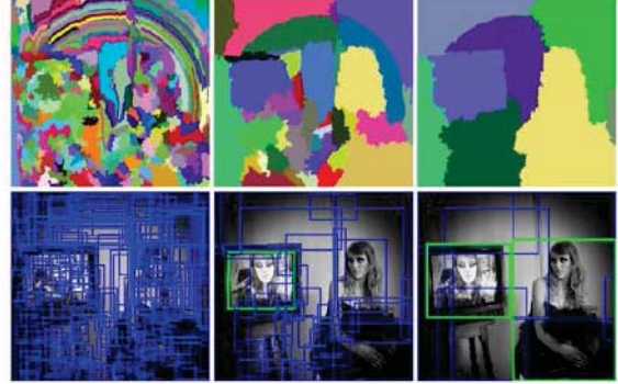
Şekil-4: Seçici arama algoritması ile insan saptaması [44]
