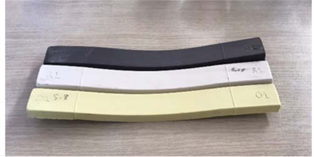
Şekil 2. Pişirim sonrası deformasyona uğramış örnekler (Deformed samples after firing)
