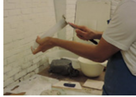
Görsel 16. Hazırlanan çamurun tüplere konulması
