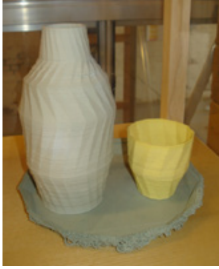
Görsel 4. Renkli çamurla üç boyutlu yazıcı harç yığıma örneği, Unfold ekibi stratigraphic porselen projesi, 2009
