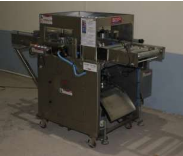
Şekil 10. Üst yaşlı misel dokusu sıyırma makinesi
